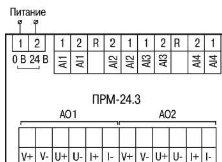
Рисунок 5.2 – Назначение контактов клеммника прибора с питанием 24 В
