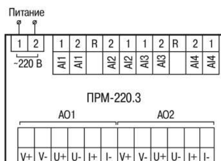
Рисунок 5.3 – Назначение контактов клеммника прибора с питанием 230 В
